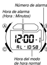
Se pueden ajustar cinco alarmas diarias independientes. Cuando una alarma se encuentra activada, el tono de alarma suena cuando se llega a la hora de alarma. Una de las alarmas puede configurarse como una alarma de despertador o una alarma que suena una vez, mientras las otras cuatro son alarmas que suenan una sola vez. También puede activar la señal horaria que ocasiona que el reloj emita dos zumbidos a cada hora sobre la hora ajustada.
