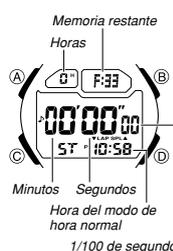
El cronógrafo de 1/100 de segundo puede medir el tiempo transcurrido y tiempos de vuelta/fracción. El cronógrafo utiliza los datos básicos que ha ingresado y una señal de marcación de ritmo, para calcular la distancia que ha cubierto mientras trotas o corres. Los tiempos del cronógrafo y su distancia son también almacenados en la memoria.
