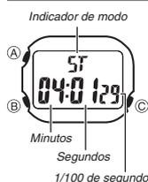
El modo de cronógrafo le permite medir el tiempo transcurrido, tiempos fraccionados y dos tiempos de llegadas a meta. La gama del cronógrafo es 59 minutos y 59,99 segundos.
